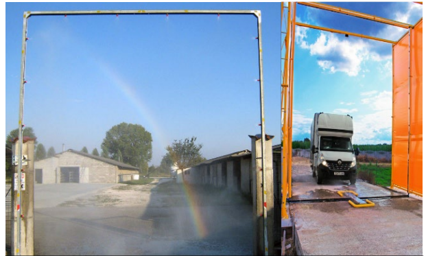
Exemples de portiques de désinfection
