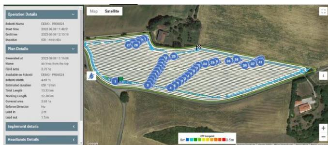
Le robot a rencontré des difficultés avec la topographie de la parcelle (pente et dévers de 20 % environ). Un reparamétrage du robot a été nécessaire, notamment concernant la vitesse de travail qu'il fallait diminuer à 4 km/h. Après quelques essais et réajustements en direct avec la hotline au Danemark, le semis de carotte a pu se poursuivre.
